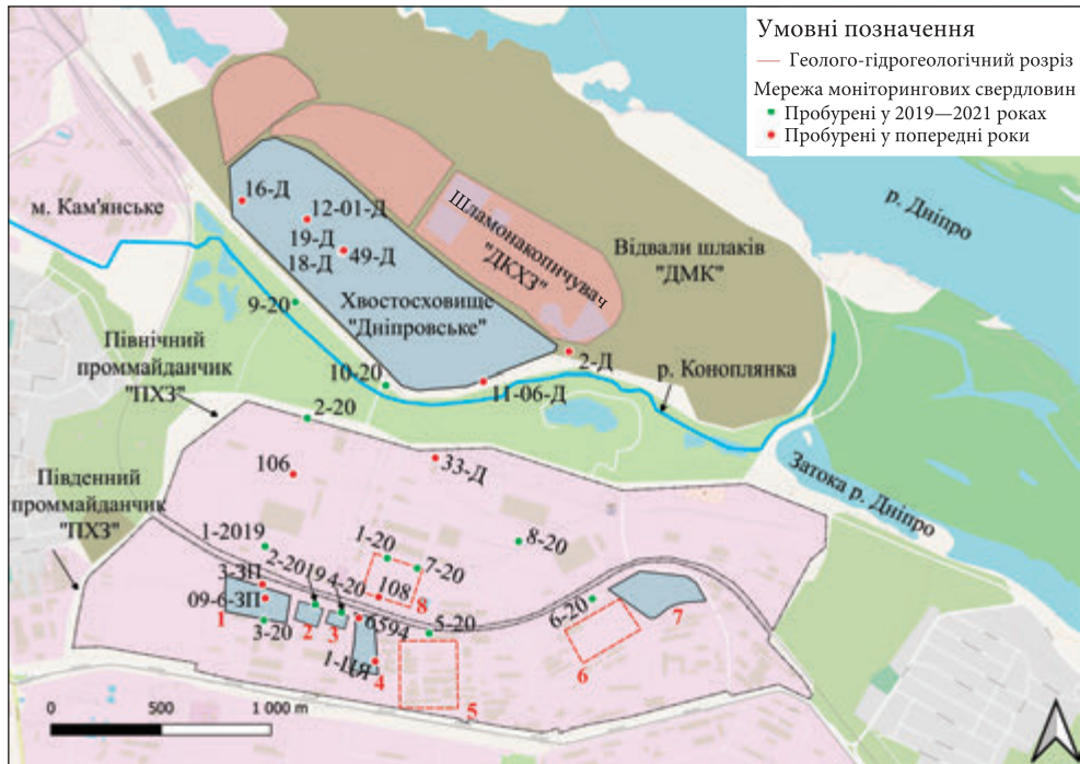
Рис. 1. Ситуаційна схема промислового майданчика ПХЗ і хвостосховища «Дніпровське»: 1 — хвостосховище «Західне»; 2 — відстійник № 220; 3 — відстійник № 230; 4 — хвостосховище «Центральний Яр»; 5 — комплекс радіохімічних цехів; 6 — майданчик розвантаження уранової руди; 7 — хвостосховище «Південно-східне»; 8 — «історичний» відстійник на Північному майданчику
