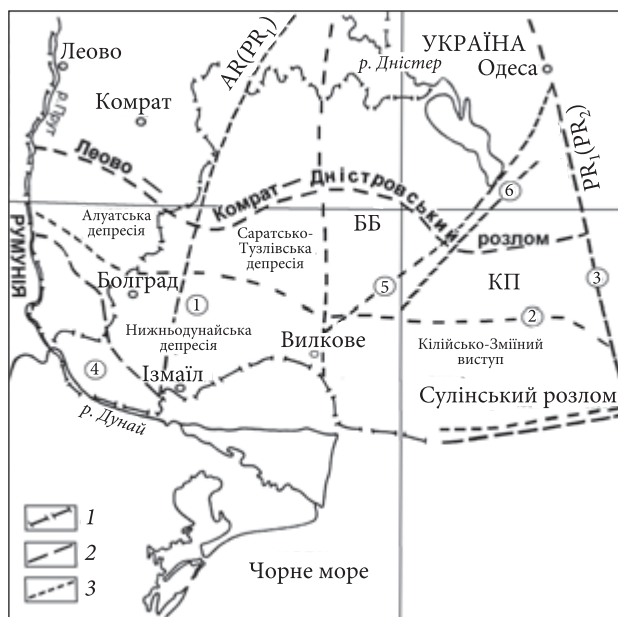
Рис. 1. Структурні елементи Переддобрудзької крайової системи і головні депресії (Гарецький і др., 1988): 1 — державні кордони країн; 2 — обмежуючі розломи; 3 — інші тектонічні порушення. Цифри у колі: 1 — Орхівський виступ, 2 — Болградський розлом, 3 — Одеський розлом, 4 — Прутський виступ, 5 — Алібейський розлом, 6 — Чорноморський розлом. КД — Криловський прогин, ББ — Білоліський блок
