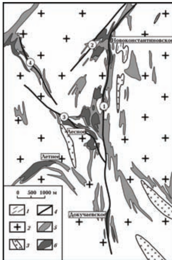
Рис. 16. Пространственные соотношения разломов, натровых метасоматитов и урановых месторождений на площади Новокопстантиновского рудного поля: 1 — гнейсы; 2 — гранитоиды; 3 — монзониты; 4 — разломы; 5 — десилицированные породы; 6 — альбититы. Названия месторождений обозначены в прямоугольниках.
