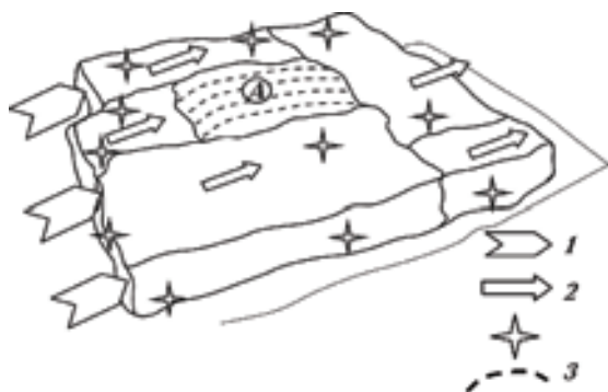
Рис. 11. Объемная модель системы подготовки землетрясения при движении блоков под действием тектонических сил: 1 — общее направление движения всей системы блоков; 2 — направление движения отдельного блока; 3 — землетрясения малого энергетического класса; 4 — деформация растяжения, возникающая при остановке блока А.
