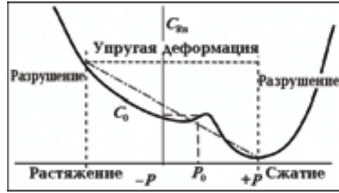
Рис.2. Качественная характеристика изменения объемной активности радона в горной породе при изменении внешней нагрузки на массив породы.
