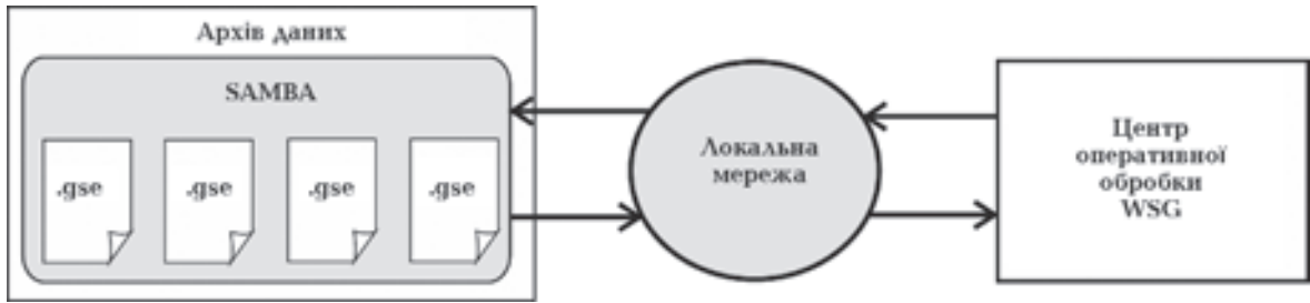
Рис. 6. Схема передавання цифрових сейсмічних даних з архіву до Центру оперативної обробки за допомогою програми Samba.
