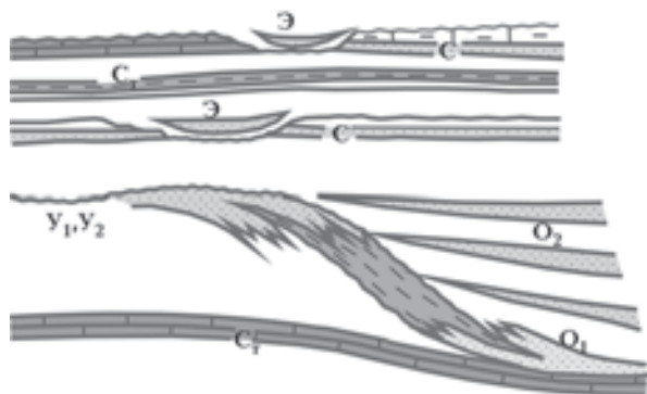
Рис. 8. Упрощенная породослоистая модель осадочного макрокомплекса, сформированного на протяжении элементарного геосинклинального цикла (Т-фазы): У_1, У_2 — отложения I и II субфаз углубления прямоклиноформного строения со стратиграфическим экранированием под поверхностью несогласия, контролируемые ундаформными частями клиноформ; О_1, О_2 — отложения I та II субфаз обмеления с литологическим экранированием над поверхностью несогласия, контролируемые фондоформными частями клиноформ ( О_1 ) и обратноклиноформными ( О_2 ); Ст — покровные отложения субфазы стабилизации (тектонического покоя или инверсии); С — покровные отложения субфазы стабилизации со стратиграфическим экранированием поверхностями эрозионных врезов; Э — полосообразные породные тела выполнения эрозионных врезов с литологическим экранированием.
