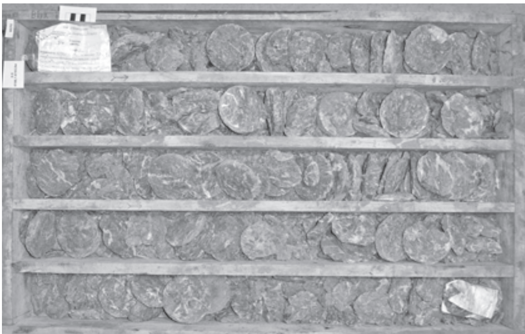
Рис. 9. Керн нижнекаменноугольных пород в интервале глубин 6186,1—6193,6 м.
