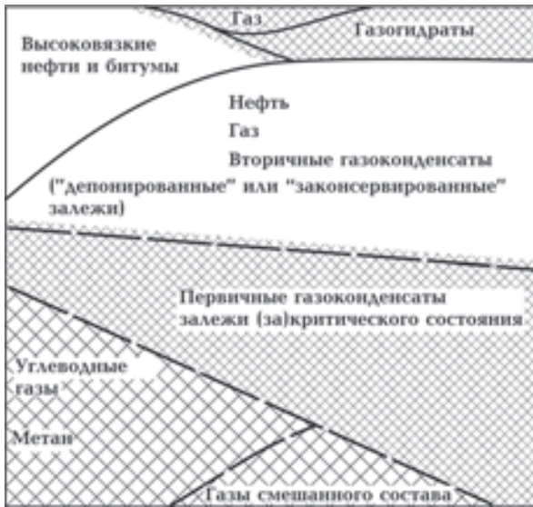
Рис. 3. Сводная схема зональности нафтидоаккумуляции в осадочной оболочке Земли (стратифере) [Лукин, 2008].
