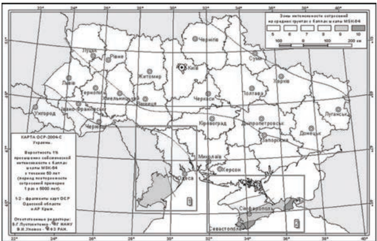
Рис. 1. Генеральна карта загального сейсмічного районування території України (ЗСР-2004-С для періоду повторюваності землетрусів 5000 років) [Пустовитенко и др., 2006].
