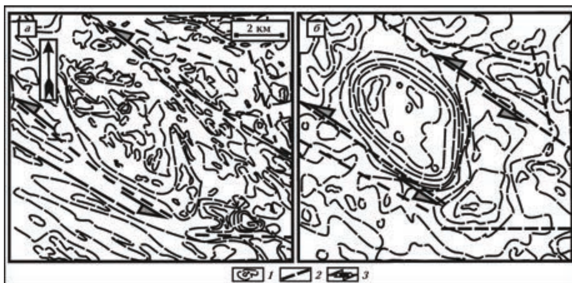
Рис. 4. Фрагменты карты изодинам Z_a (а) и \delta\Delta g (б) участка Троянского массива: 1 — изодинамы Z_a и \delta\Delta g , 2 — зоны скалывания, 3 — левый сдвиг.
