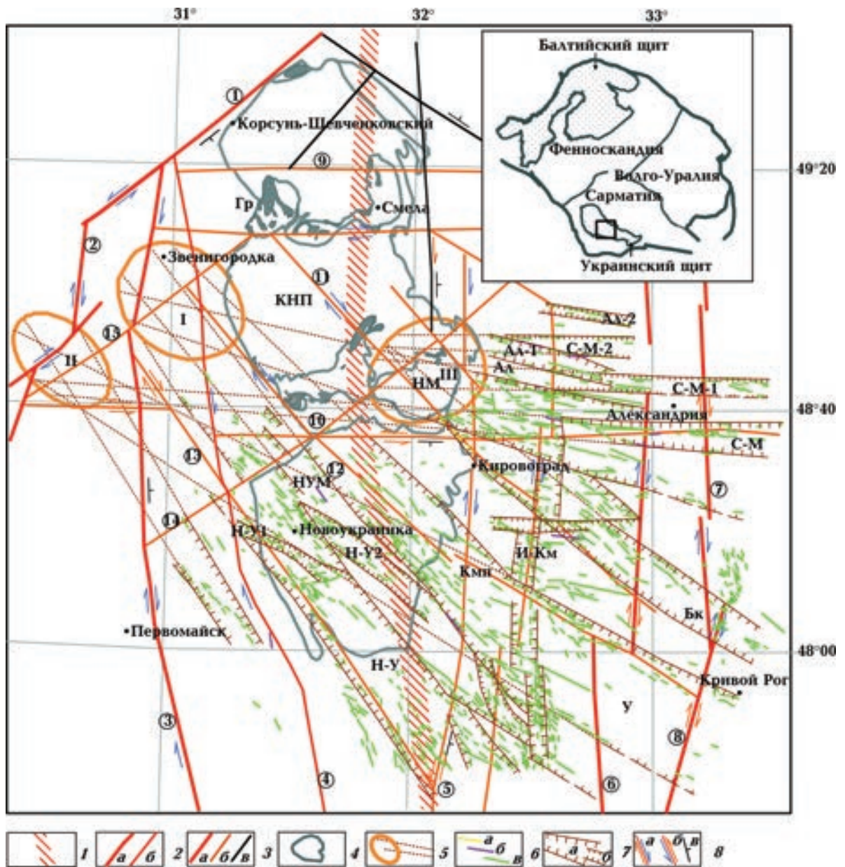
Рис. 1. Распространение мафических даек в сопоставлении с разломной тектоникой Ингульского мегаблока: 1 — зона раздвига Херсон—Смоленск; 2 — зоны разломов первого (а) и более высокого рангов (б); 3 — зоны разломов, образовавшихся: в начале раннего протерозоя (PR 1 -I) (а), в конце раннего протерозоя (PR 1 -II) (б), возраст не установлен (в) [Кировоградский ..., 2013; Гинтов, 2014]; 4 — контуры Новоукраинского (НУМ) массива, Корсунь-Новомиргородского плутона (КНП), массивов габбро-анортозитов; 5 — узлы пересечения "трасс" роев даек (I — НКА, (Новоукраинского, Компанеевского, Александровского), II — УС-М (Устиновского, Субботско-Мошоринского), III — С-МБк (Субботско-Мошоринского, Субботско-Мошоринского 1, Субботско-Мошоринского 2, Боковьянского)); 6 — дайки: кимберлитов (а); пикритов (б); диабазов (в); 7 — рои даек: главные (а), "второго порядка" (б); 8 — кинематические знаки (синие — во время заложения, желтые — при главной фазе активизации, а — правый сдвиг, б — левый сдвиг, в — направление падения). Зоны разломов: (цифры в кружках): 1 — Ядлов-Трактимировская, 2 — Тальновская, 3 — Первомайская, 4 — Звенигородско-Братская, 5 — Кировоградская, 6 — Западно-Ингулецкая, 7 — Искровская, 8 — Криворожско-Кременчугская, 9 — Смелянская, 10 — Субботско-Мошоринская, 11 — Лелековская, 12 — Нерубаево-Лозоватская, 13 — Новоукраинская, 14 — Глодосская, 15 — Мошуровская (зона скальвания). Рои даек: Ал, Ал1, Ал2 — Александрийский, СМ, С-М1, С-М2 — Субботско-Мошоринский, Бк — Боковьянский, У — Устиновский, Кмп — Компанеевский, Н-У — Новоукраинский, Н-У1 — Новоукраинский 1, Н-У2 — Новоукраинский 2, И-Км — Ингуло-Каменский; массивы габбро-анортозитов: НМ — Новомиргородский, Гр — Городищенский.
