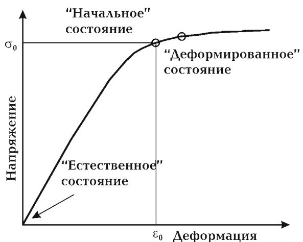
Определение «естественного», «начального» и «деформированного» состояний в нелинейной упругой механике.
