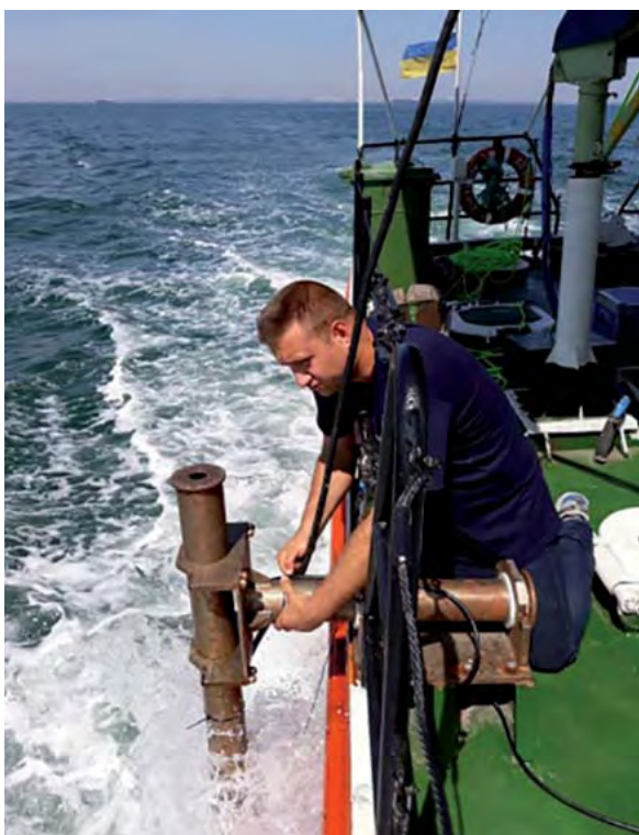
Рис. 1. Монтування антени гідролокатора бічного огляду модернізованого гідроакустичного комплексу на борту судна.
