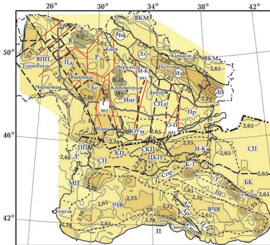
Рис. 3. Схема распределения плотности ( \text{г/см}^3 ) на поверхности фундамента. Условные обозначения см. на рис. 1.
