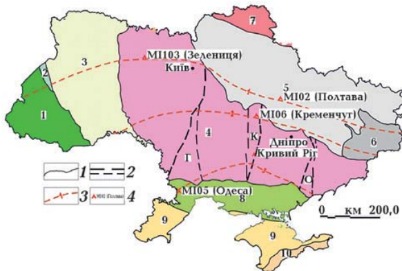
Рис. 7. Схема тектонічного районування України [Тектонічна ..., 2007] з ізосейстами та розташуванням сейсмологічних станцій: 1 — межі границі геоструктур; 2 — шовні зони; 3 — ізосейсти; 4 — сейсмологічна станція та її номер (назва). Геоструктури (цифри на карті): 1 — Карпатський мегантикліній; 2 — Рава-Руська епіорогенна зона, 3 — Волино-Подільська плита, 4 — Український щит, 5 — Дніпровсько-Донецька западина, 6 — Складчастий Донбас, 7 — Воронежський кристалічний масив, 8 — Південноукраїнська монокліналь, 9 — Скіфська епіорогенна зона, 10 — Кримський меганіпторій. Шовні зони: Г — Голованівська, К — Криворізько-Кременчуцька, О — Орхів-Павлоградська.
