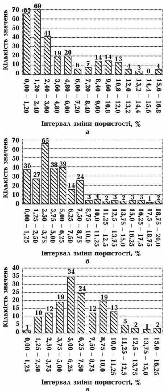
Рис. 1. Результати петрофізичних визначень пористості згідно з [Вижва та ін., 2012]: а — бімодальний з максимумом у капілярах і мікропорах, б — унімодальний неоднаковий з максимумом у менших капілярних порах, в — унімодальний рівномірний з максимумом у великих капілярних порах.
