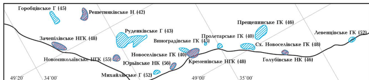
Рис. 5. Розподіл розрахованих середніх значень ТП вздовж Південного борту центральної частини ДДЗ з врахуванням температур в продуктивних пластах. Інші умовні позначення див. на рис. 2.
