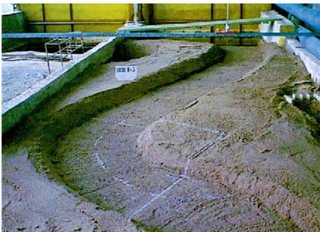
Рис. 5. Фізична модель криволінійного розмивного русла, підготовлена до експерименту [11].
