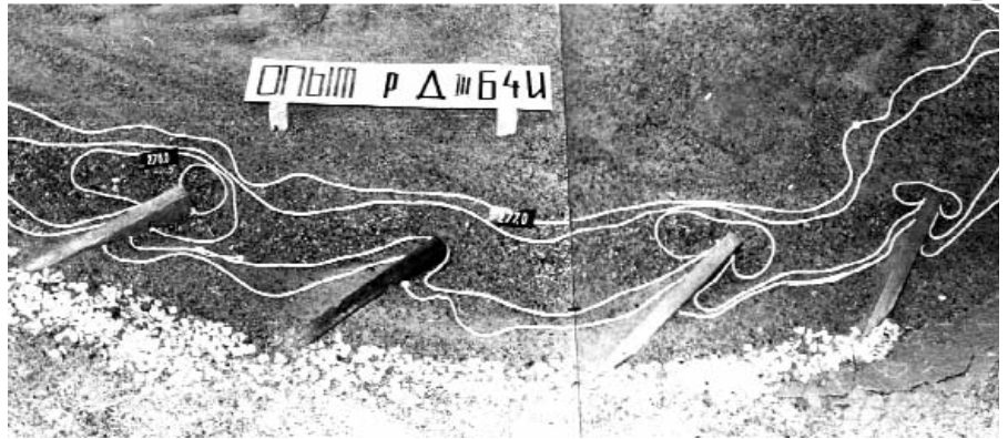
Рис. 6. Розмив дна біля системи з п'яти напівзагат
