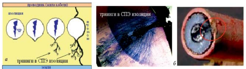
Рис. 10. Эволюция распространения дефекта с последующим пробоем полиэтиленовой изоляции [17, 29] (а); разрушение силовых кабелей вследствие частичных разрядов [30, 31] (б).
