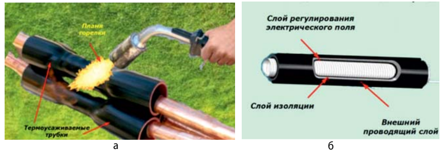
Рис. 8. Установка термоусаживаемых трубок (а); расположение трубки-регулятора холодной усадки (б) [14].
