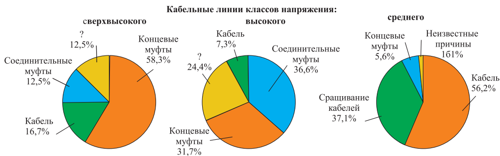
Рис. 3. Причины аварий и повреждений кабельных линий различного класса напряжения [8, 9]. Диаграмма справа представляет статистику повреждений кабельных линий среднего напряжения в Северной Америке.
