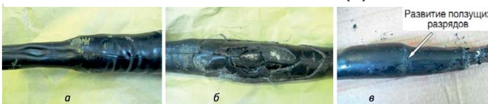
Рис. 27. Неравномерная усадка термоусаживающего материала в соединительной муфте Raychem с образованием воздушных полостей, что привело к развитию ионизационного пробоя (а); характерное повреждение муфты после испытания (б); развитие ползущих разрядов (в) [72].
