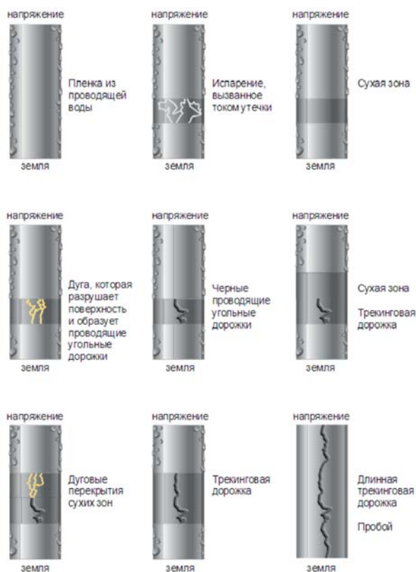
Рис. 5. Образование трекинговых дорожек на поверхности концевых муфт [4].
