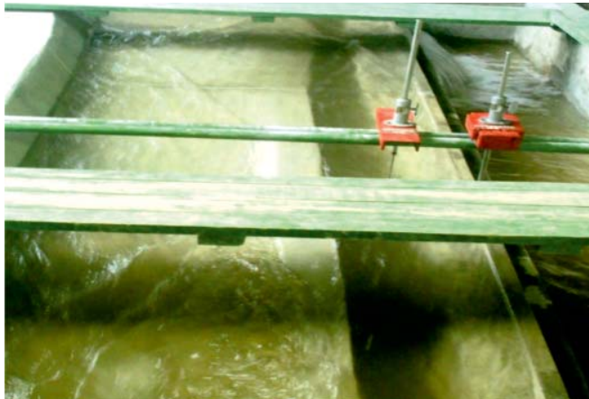
Рис. 3. Лабораторні дослідження бокового водозабору протипаводкової акумулюючої ємності "Тершаків" на р. Бистриця у Львівській обл.
