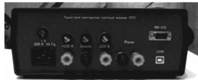
Рис. 5. Зовнішній вигляд приладу ПКІ – задня панель
