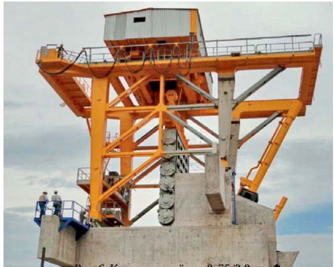
Рис. 6. Кран козловой г.п. 2x75/3,2 т, ГЭС Ла Еска, Мексика
