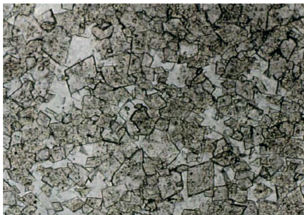
Рис. 5. Свердловина 1-Східносаратська, інтервал 2984–2992 м. Доломіт тонкозернистий з кальцитовим цементом (білий фон). Шліф, 150 \times
