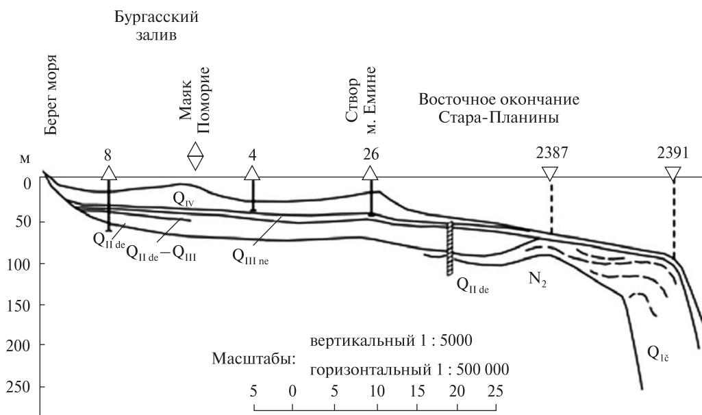
Рис. 2. Геологический разрез болгарского шельфа от Бургасского залива до Восточного окончания Восточной Стара-Планины
