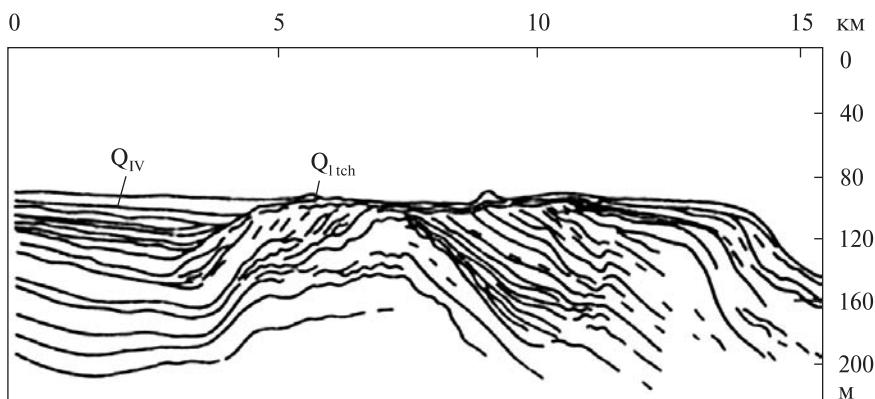
Рис. 3. Сейсмогеологический профиль внешней области шельфа в районе подводного продолжения Восточной Стара-Планины
