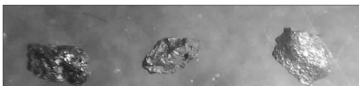
Рис. 19. 3. Сплави заліза техногенного походження під бінокляром, фракція 0,25—0,5 мм
