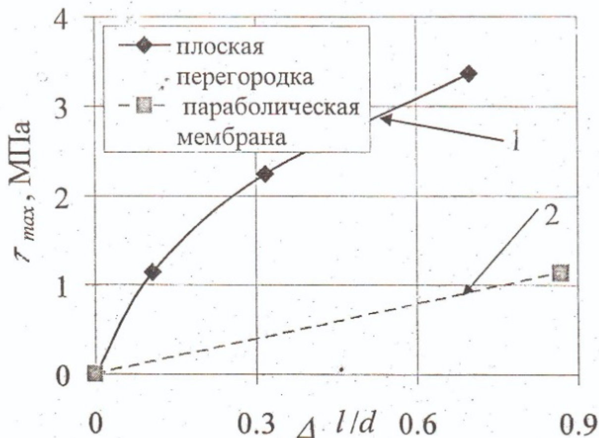
Рис. 3 - Удаление критических мест концентрации максимального касательного напряжения от контура ствола при двух вариантах перекрытия его сечения
