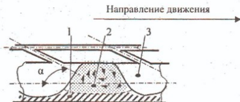
Рис. 3 - Схема формирования волны сыпучего материала в пневмотранспортном трубопроводе
