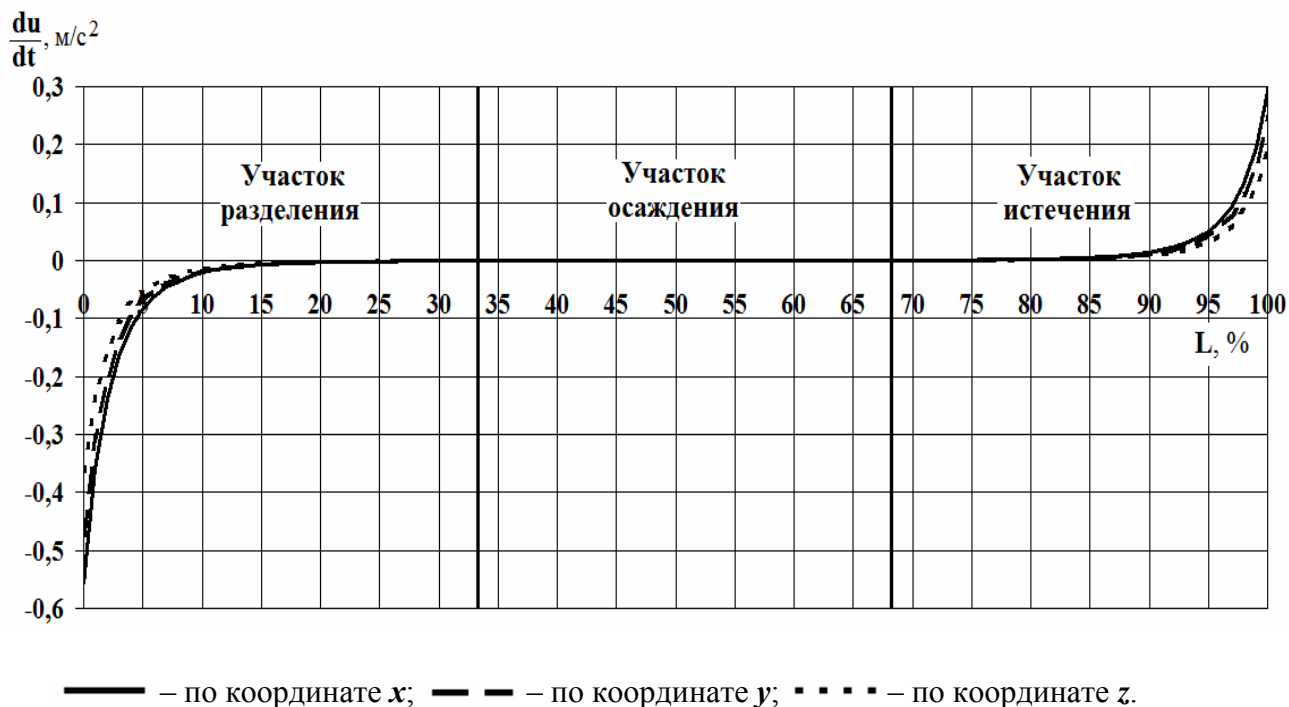
Рисунок 3 - Ускорение потока в классификаторе гидравлическом горизонтальном.
