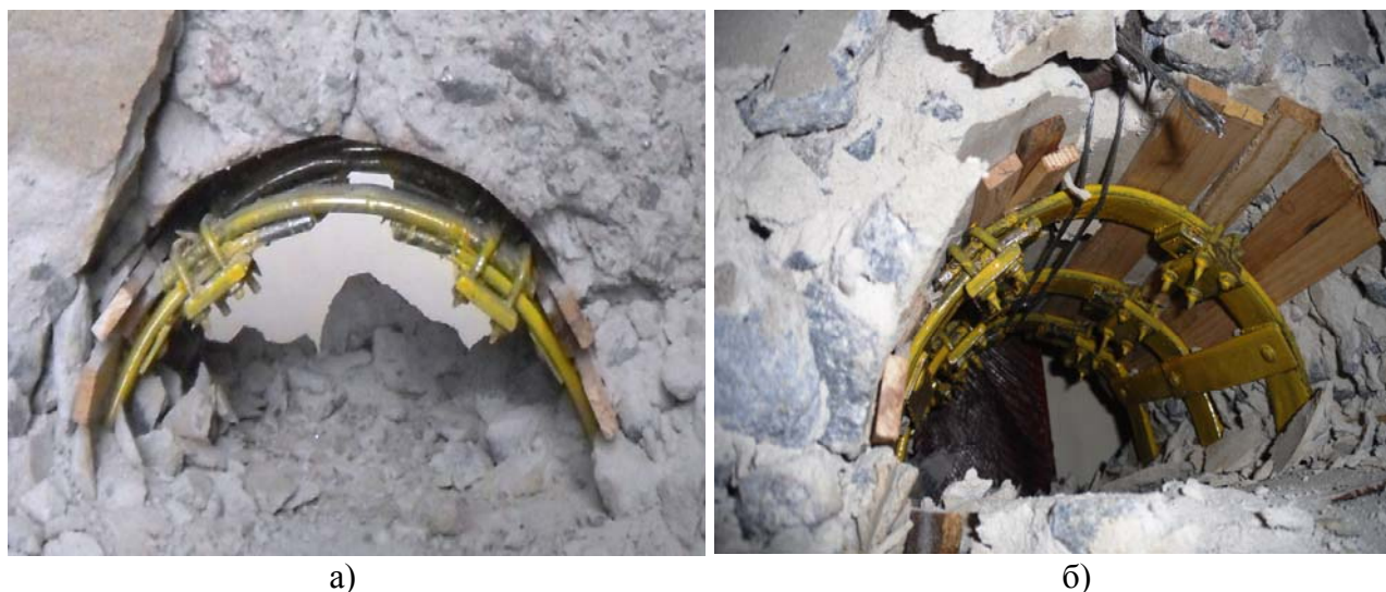
Рисунок 7 – Обрушение мелких блоков при испытаниях первой модели (а) и поддержание мелкоблочной структуры в кровле при испытаниях второго варианта модели (б)
