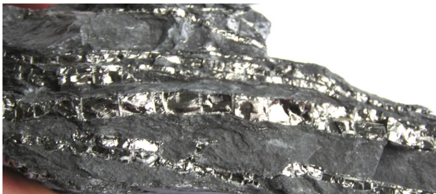
Рисунок 2 - Штуф угля, угольный пласт m_3 – «Толстый», марка Ж, горизонт 1146 м, АП «Шахта им. Ф.Э. Дзержинского» ГП «Дзержинскуголь», ув. 5 крат; фотоснимок
