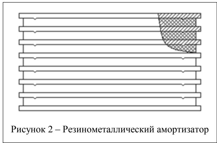
элемента 0,14 м, толщина резинового элемента 0,035 м, металлического слоя – 0,004 м., количество элементов – 7.
