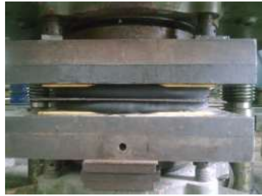
Рисунок 5 – Общий вид РСБ диаметром 500 мм под нагрузкой 3000 кН
