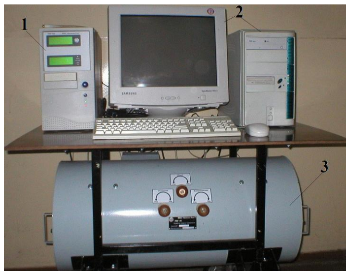
1 – электронный блок измерения УКГФ; 2 – компьютерное обеспечение УКГФ; 3 – термостат с оборудованием УКГФ
