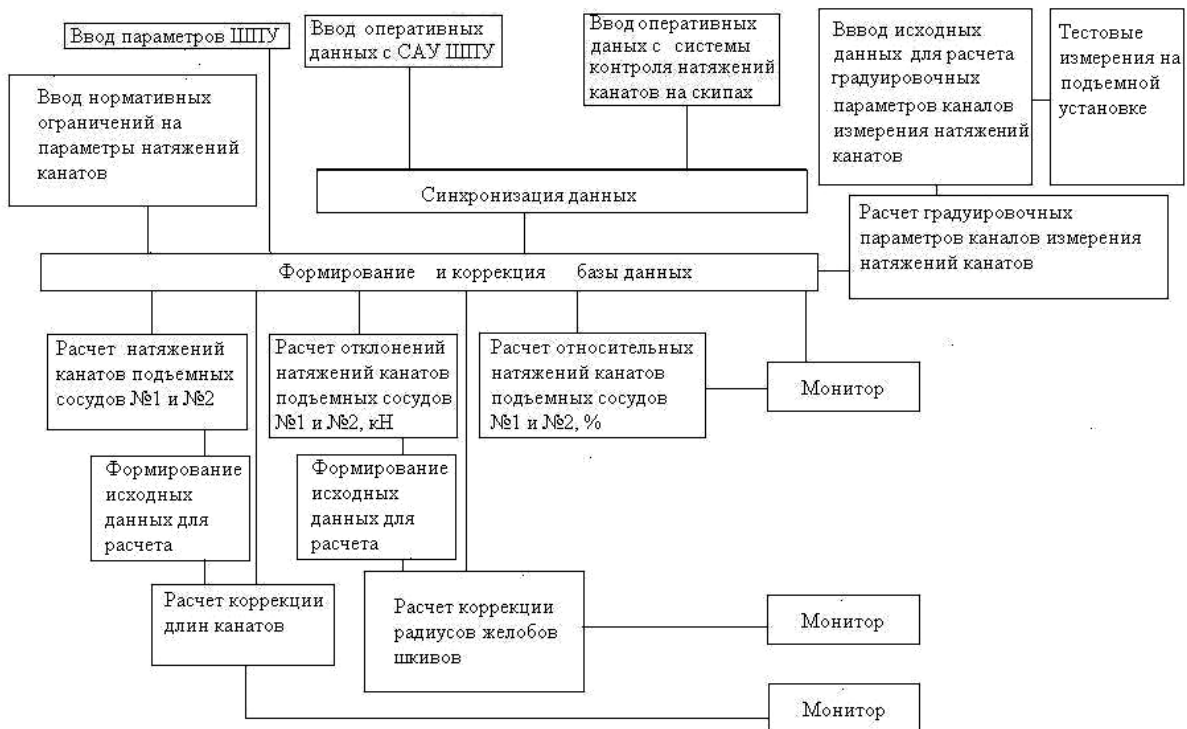
Рисунок 2 - Функциональная схема программного обеспечения комплекса контроля натяжений канатов
