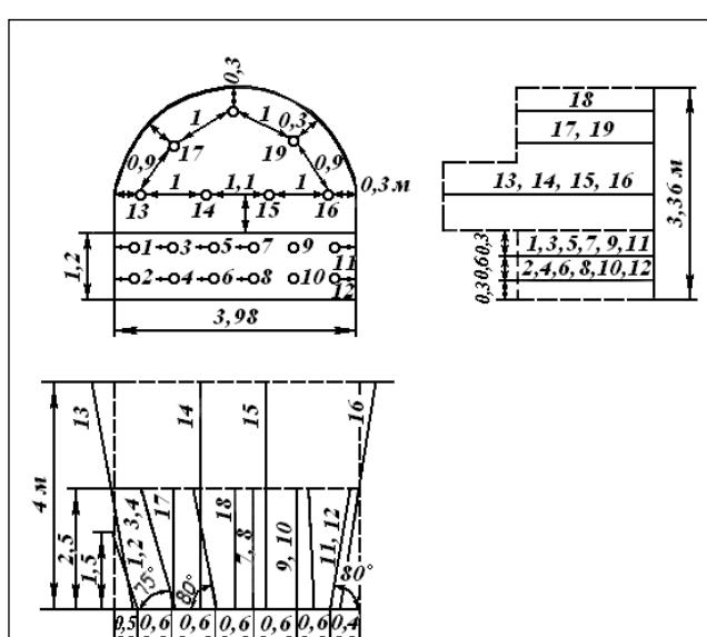
Рисунок 1 – Схема расположения шпуров с предварительным рыхлением пород, вмещающих выбросоопасный пласт
