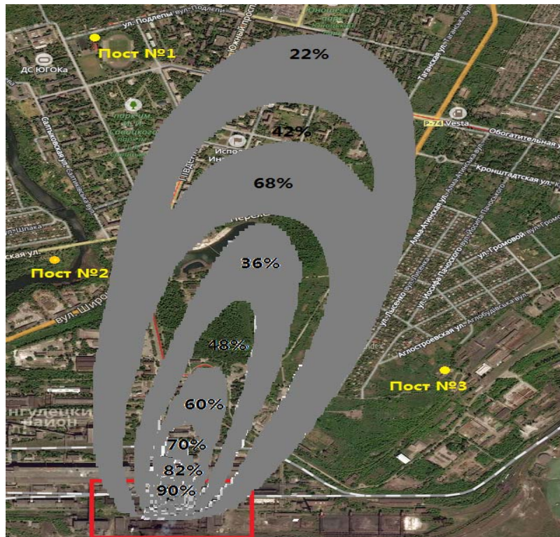
Рисунок 4 – Зона загрязнения оксидом углерода, источники загрязнения – горно-обогатительный комбинат и автомагистраль U=6 м/с
