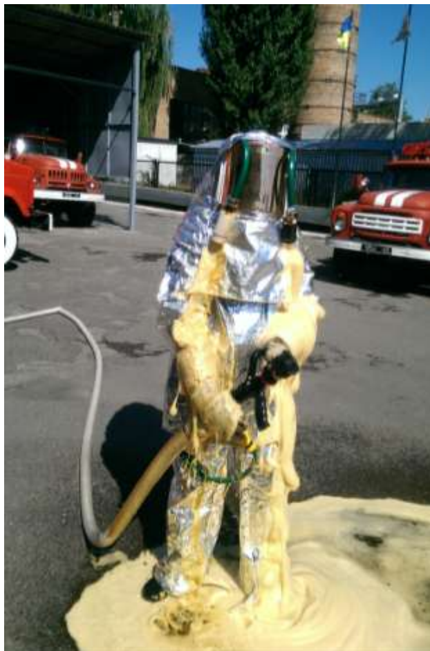
Рисунок 2 - Макетний зразок пінного охолоджуючого пристрою теплозахисного костюму
