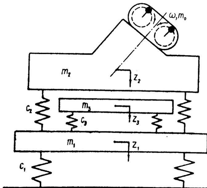
$m_1$  – масса рамы грохота;  $m_2$  – масса рабочего органа грохота дебалансами;  $m_3$  – дополнительная масса;  $c_1$  – жёсткость виброизоляторов рамы;  $c_2$  – жёсткость виброопор грохота;  $c_3$  – жёсткость упругих связей дополнительной массы
