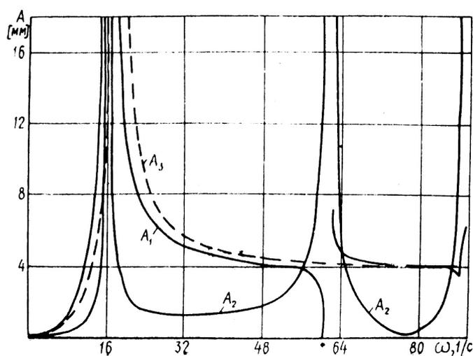
$A_1$  – амплитуда колебаний корпуса грохота с виброизоляцией;  $A_2$  – амплитуда колебаний рамы грохота с виброизоляцией;  $A_3$  – амплитуда колебаний корпуса грохота, не оборудованного виброизоляцией
