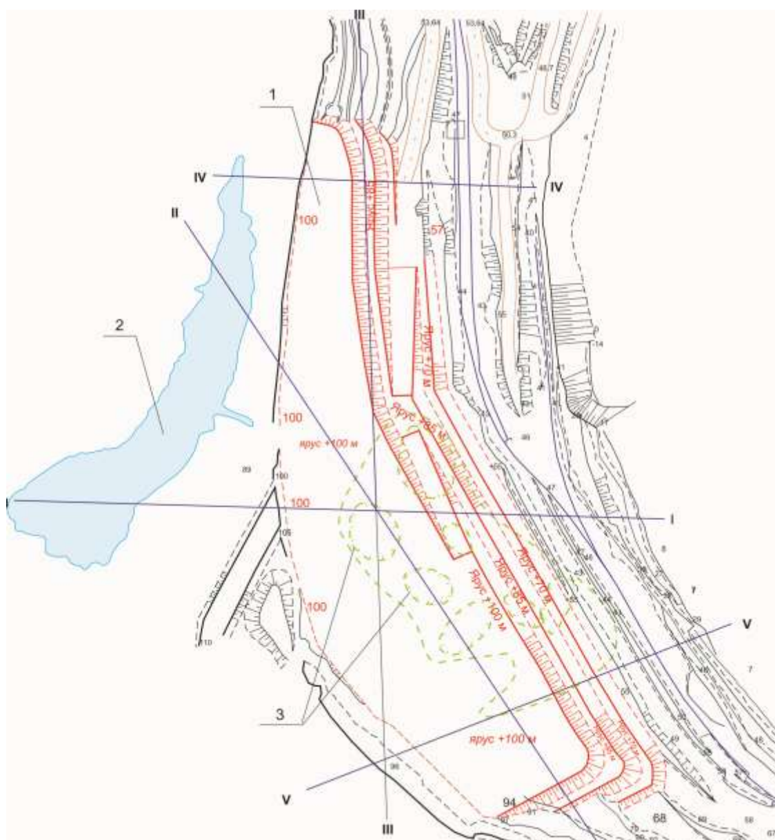
1- проектируемый отвал; 2 - пруд-аккумулятор поверхностного стока; 3 - зоны возможного воронкообразования; I-I, II-II-, III-III, IV-IV, V-V – направления разрезов
