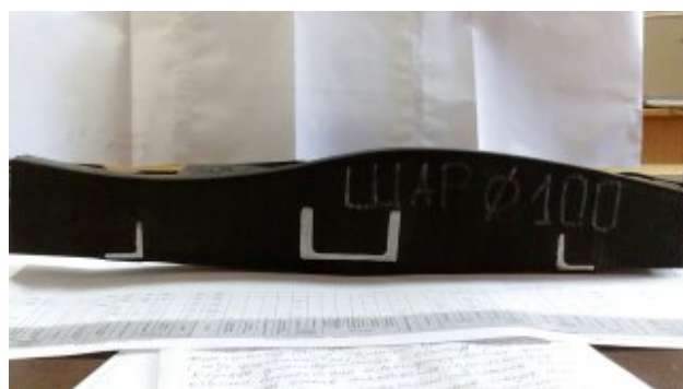
г – переріз демонтованої футеровочної плити яка працювала з кулями \varnothing 100 мм
