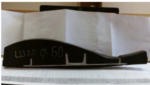
в – переріз демонтованої футеровочної плити яка працювала з кулями \varnothing 60 мм;
