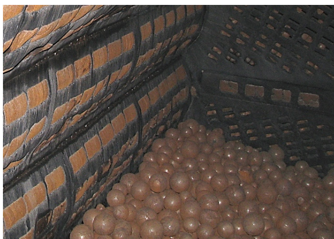
Рисунок 2 – Гумова футеровка «G.M-Хвиля»; ПівГЗК, млин (3,6 м, перша стадія подрібнення, кулі \varnothing 100 мм, t = 6,5 міс.)
