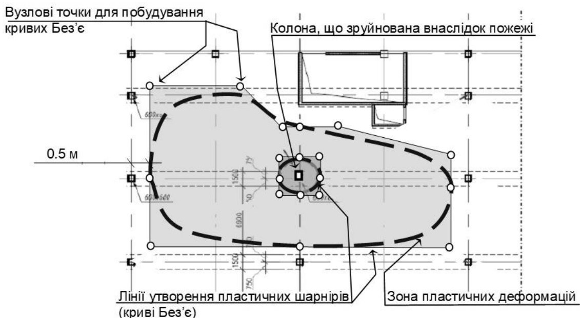
Рисунок 2 – Відтворення ліній утворення пластичних шарнірів за допомогою кривих Без'є.
