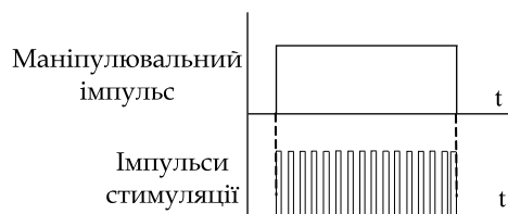
Рис. 9. Часові діаграми проходження маніпулювального імпульсу та імпульсів стимуляції
