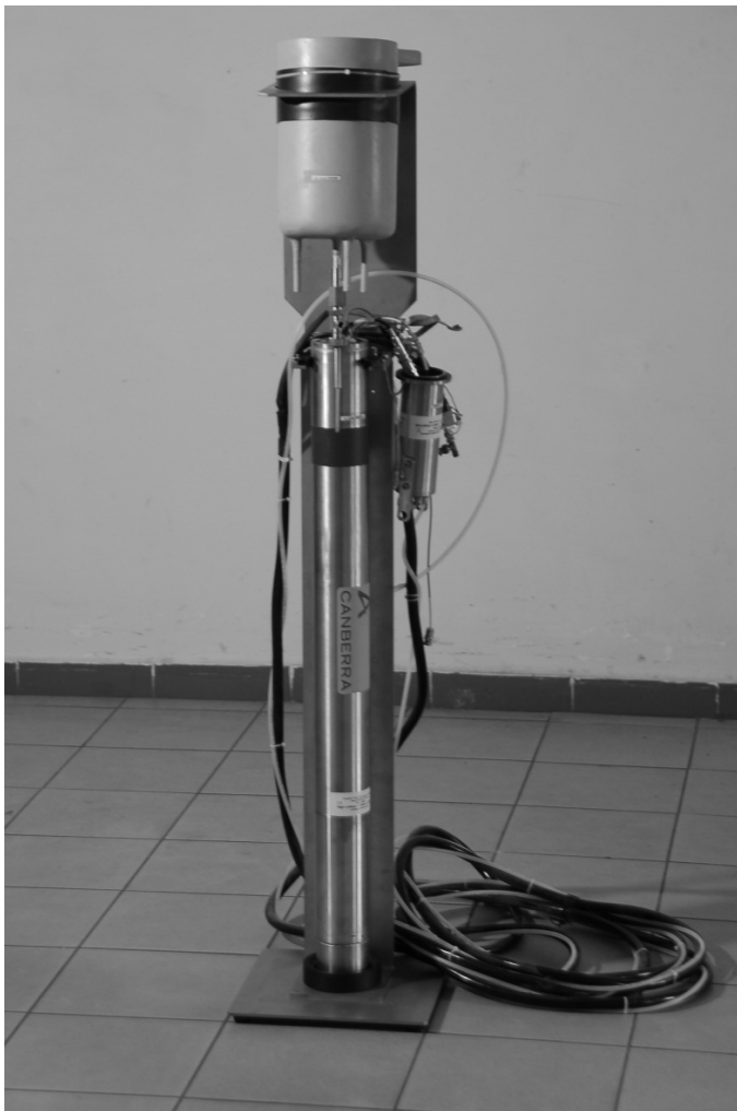
Рис. 5. Напівпровідниковий HPGe-спектрометр для проведення гамма-каротажу
