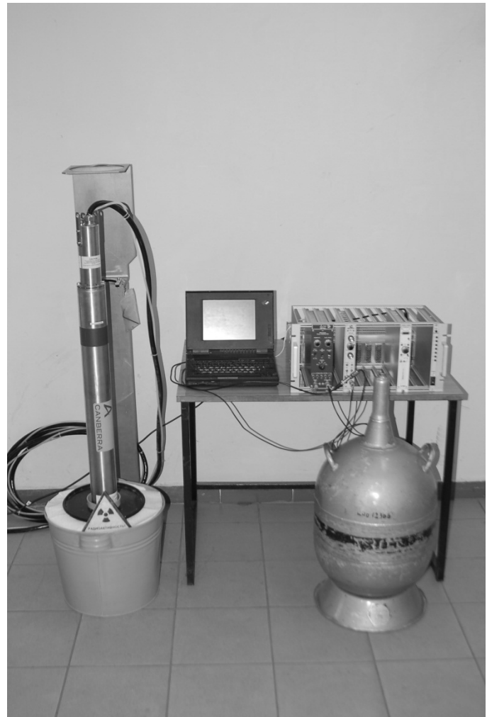
Рис. 6. Установа для вивчення особливостей проведення гамма-каротажу за допомогою модельної свердловини
