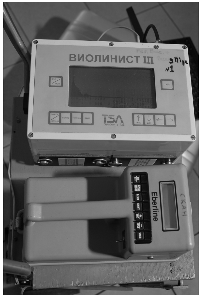
Рис. 3. Аналізатор ВІОЛІНІСТ-ІІІ та реєструючий прилад ESP-2, що входять до складу пристрою “СКАНЕР”
