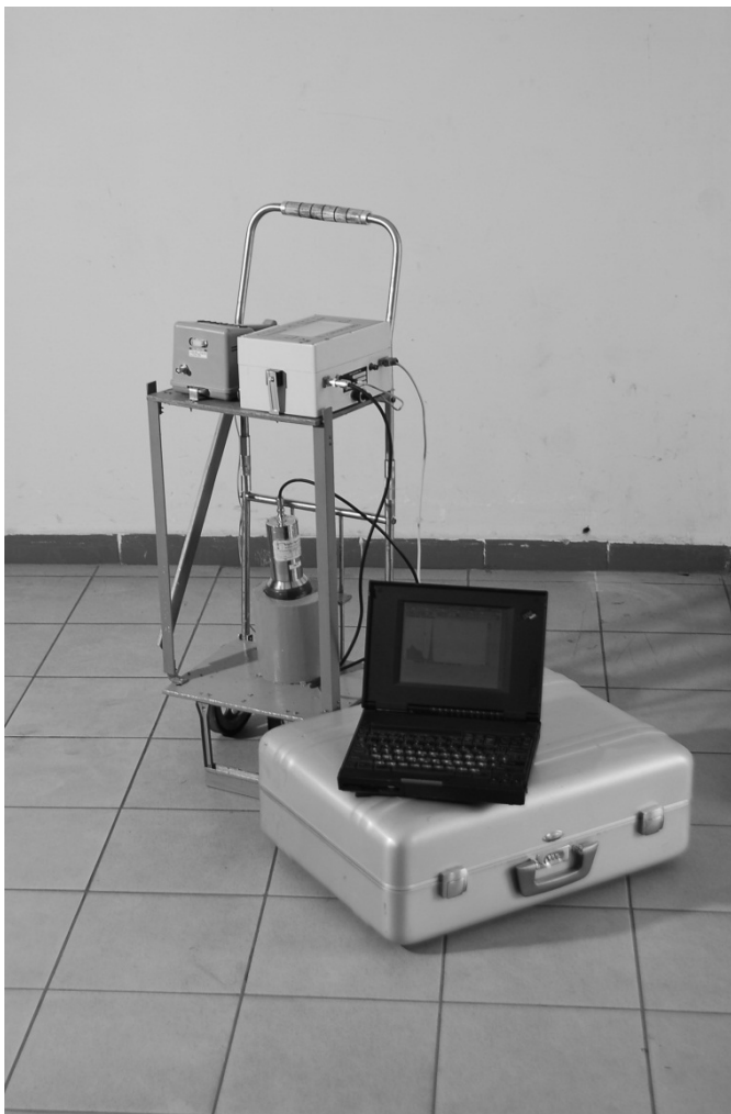
Рис. 2. Пристрій для гамма-сканування поверхні ґрунту “СКАНЕР”
