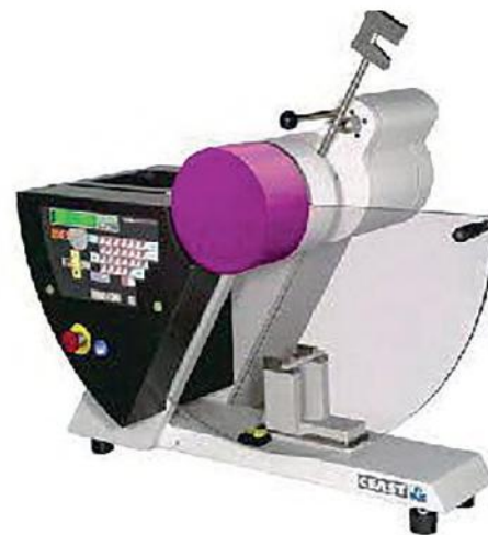
Рис. 5. Випробування зразка на ударну в'язкість методом Шарпі
