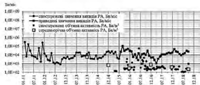
Рис. 1. Динаміка викидів РА з ПП через технологічні люки легкої покрівлі об'єкта «Укриття» (2011–2018 рр.)
