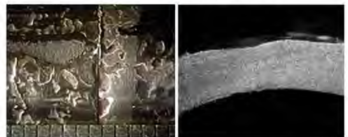
Рис. 3. Пятна коррозии на поверхности ТОТ
