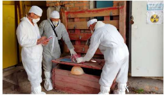
Рис. 5. Проведення радіаційних досліджень ядра із свердловини
