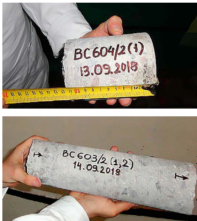
Рис. 1. Зразки-керни захисної оболонки енергоблока № 2 ВП «ЮУАЕС»
