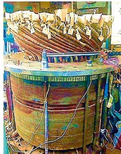
Рис. 3. Масштабна фізична модель кінцевої зони турбогенератора
