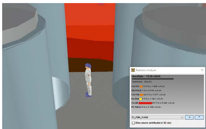
Рис. 16. Південна сторона контейнера при вимірюванні потужності дози
