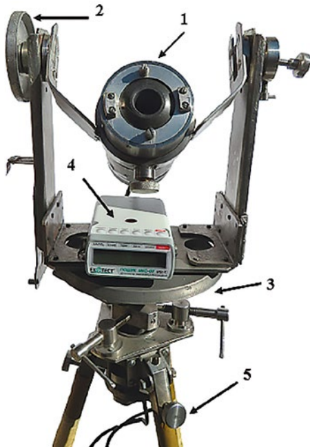
Рис. 1. Радіометр-дозиметр МКС-07 «Пошук» із виносним колімованим детектором: 1 — свинцевий корпус коліматора з детектором гамма-випромінювання БДБГ-10; 2 — лімба для встановлення коліматора з детектором у вертикальній площині; 3 — лімба для встановлення коліматора з детектором у горизонтальній площині; 4 — радіометр-дозиметр МКС-07 «Пошук»; 5 — тринога
